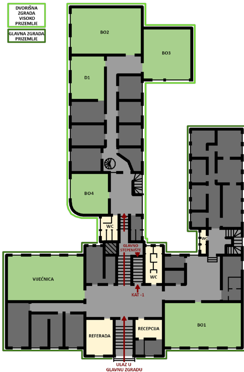
Fig. 7. Tlocrt zgrade Biološkog odsjeka na Rooseveltovom trgu 6, prizemlje glavne zgrade i visoko prizemlje dvorišne zgrade, s označenim pristupačnim hodnicima (svijetlo sivo), predavaonama i praktikumima (zeleno) te ostalim prostorijama od interesa za studente (svijetlo žuto).
